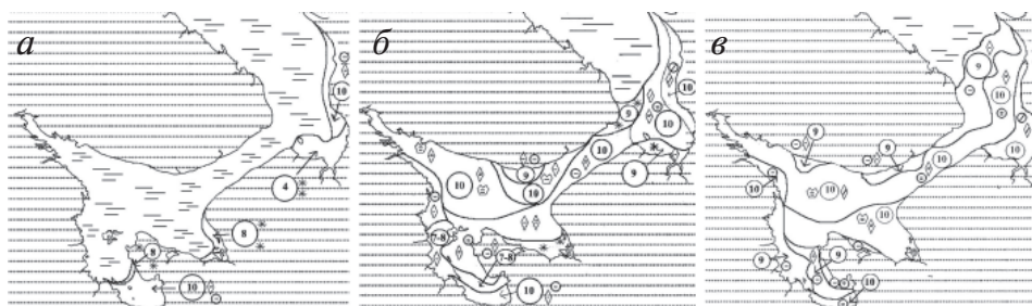
Рис. 7. Пример расчета распределения дрейфующего льда в море (6.12.1970–20.01.1971): а – начальная ледовая ситуация; б – фактическая ледовая обстановка на конец расчета; в – результат расчета
